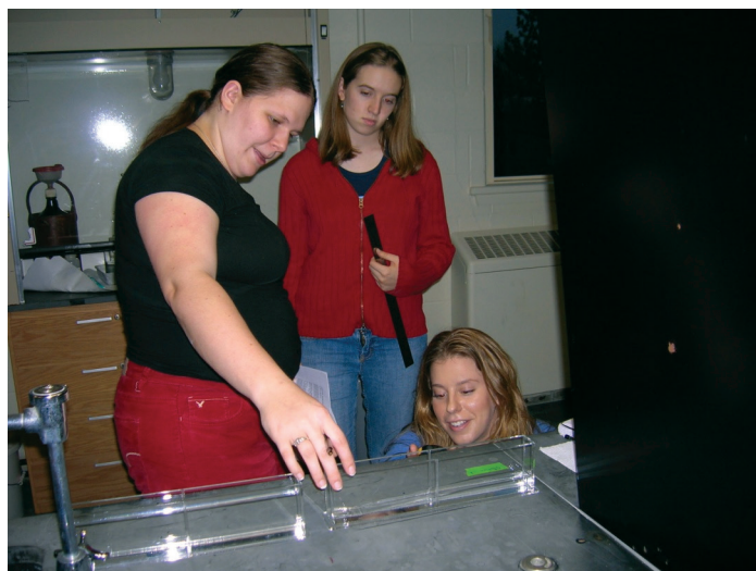
図5.1. 波の速度と波の深さ。水深1.5 cmまで水を入れた水槽で、「水撥ね」の回数を測定します。
