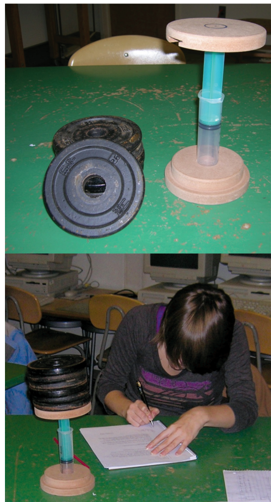
図2.6. (上) 課題2.6の材料。(下) 上に15ポンドの重りを載せた装置。
