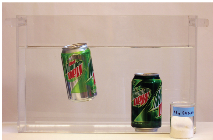
図1.2. 普通のソーダの缶(右)とダイエットソーダの缶(左)の密度の違いによる沈み方、浮き方の違い。
