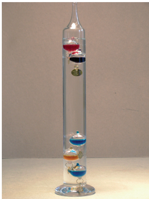
図1.7. ガリレオ式温度計。
