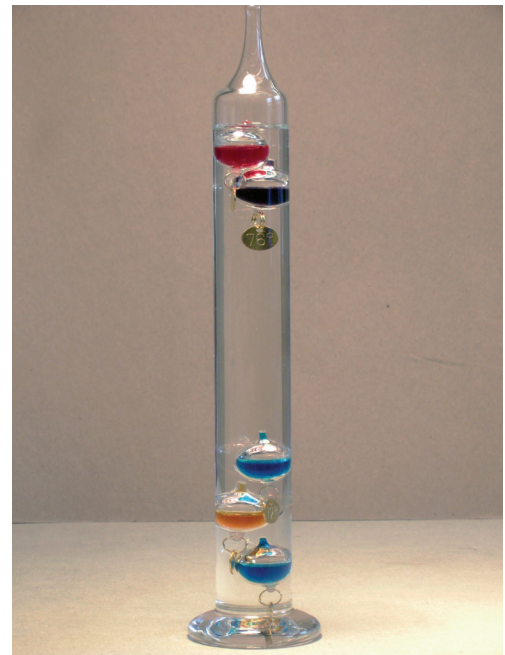
Figure 1.7. Thermomètre de Galilée.
