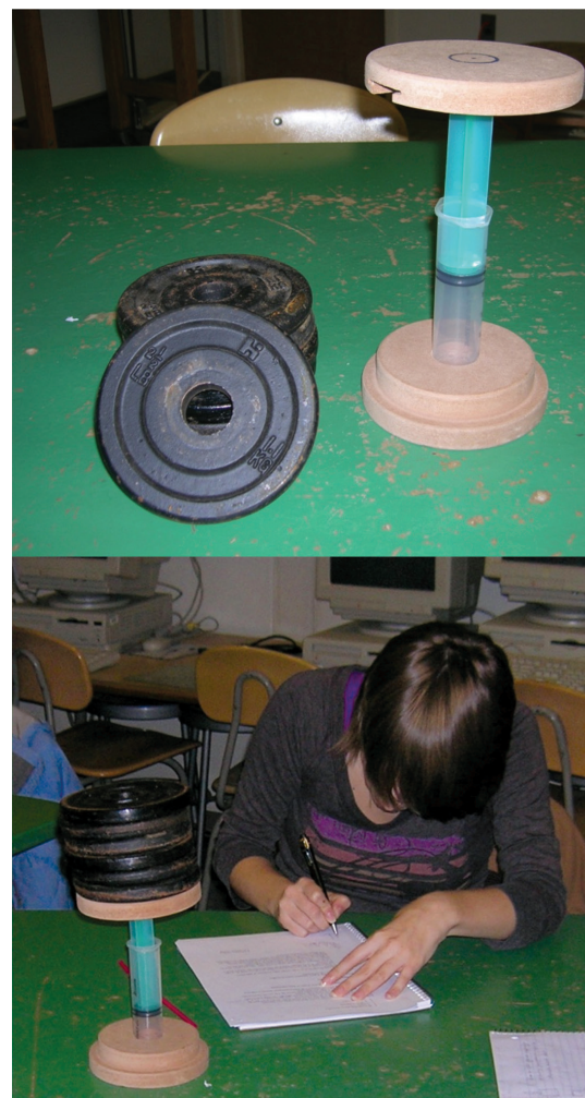
Figure 2.6. (en haut) Matériel pour l'activité 2.6. (en bas) L'appareil lesté de 15 livres.
