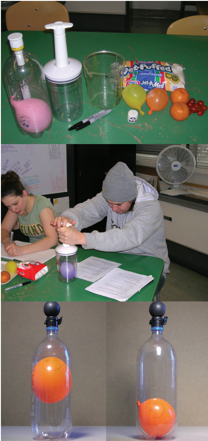
Figura 2.5. (superior) Materials per a l'Activitat 2.5. (centre) Comprovant un recipient de buit ple d'aire. (inferior) Un globus ple d'aire a pressió atmosfèrica (esquerra) i després de treure l'aire cap a l'ampolla (pressió augmentada; dreta).
