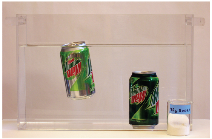
Figura 1.2. Diferència en densitats i, per tant, en enfonsament i flotació entre una llauna de beguda gasosa ordinària (dreta) i una llauna de beguda gasosa sense sucre (esquerra).
