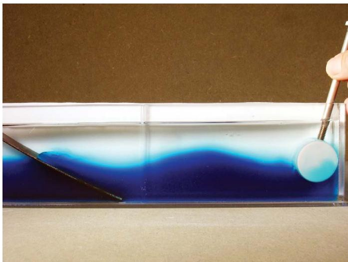
図5.2. 内部波。密度の異なる2つの流体(密度の高い青い水と、密度の低い透明な水)の界面に発生する内部波。水槽の右側には共振を実演するためのパドル(本文参照)が、左側には浅い地形を模したプラスチック片が置かれています。
