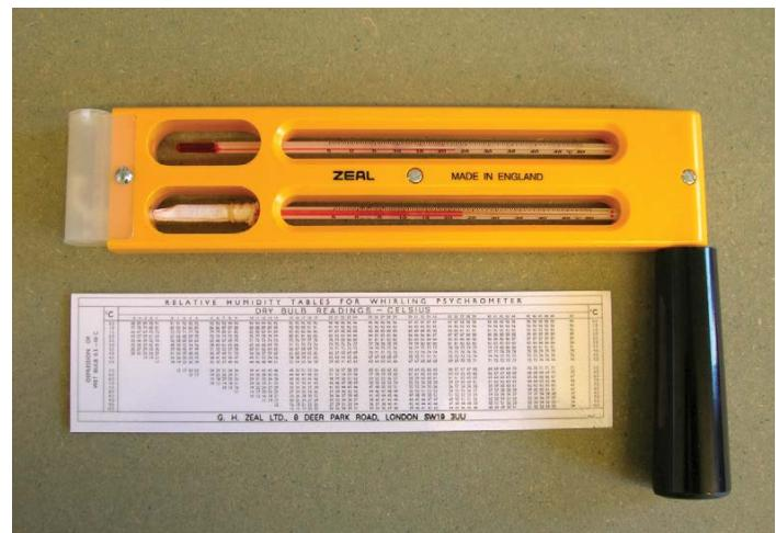
図4.6. 振り回し式乾湿計とその換算表。
