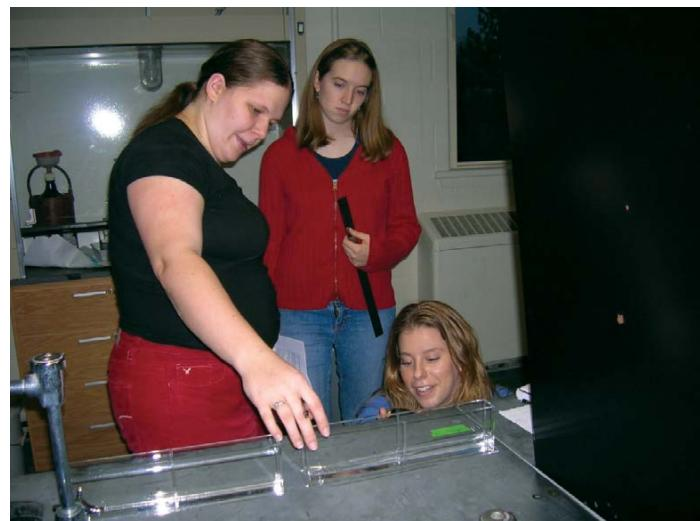
図5.1. 波の速度と波の深さ。水深1.5 cmまで水を入れた水槽で、「水撒ね」の回数を測定します。
