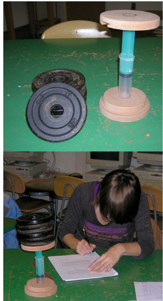
Figura 2.6. (superior) Materiales para la Actividad 2.6. (inferior) El instrumento cuando se han colocado encima 15 libras (6.8kg).
