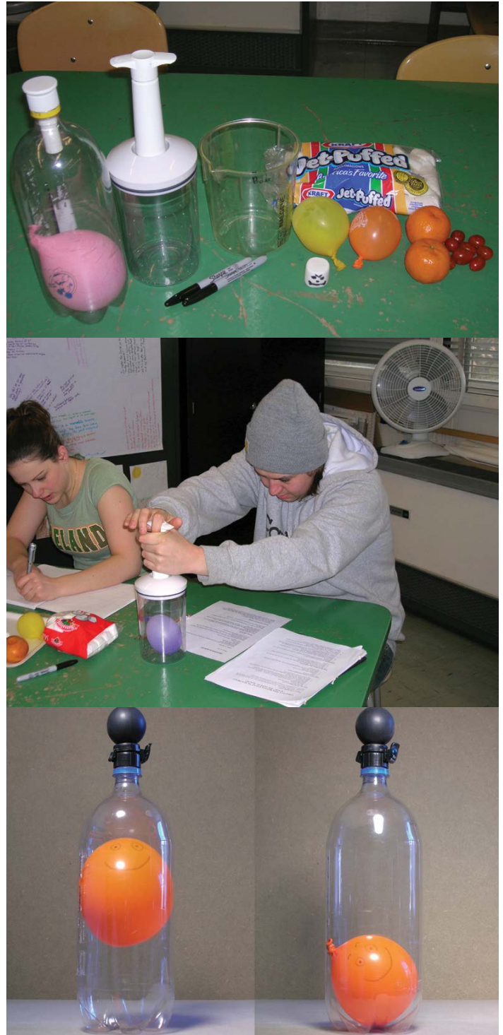
Figura 2.5. (superior) Materiales para la Actividad 2.5. (centro) Comprobando un recipiente de vacío relleno de aire. (inferior) Un globo lleno de aire bajo presión atmosférica (izquierda) y tras extraer el aire hacia la botella (presión incrementada; derecha).
