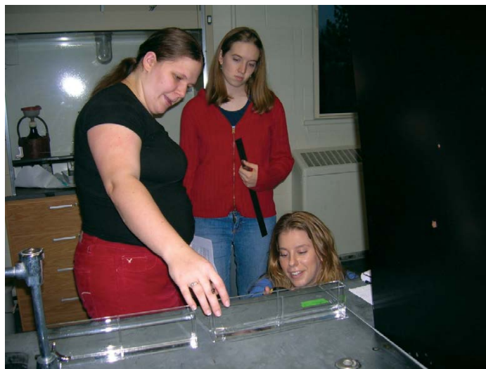
Figura 5.1. Velocidad de onda y profundidad de onda. Los estudiantes miden el número de vaivenes en una cubeta con agua hasta una altura de 1.5 cm.
