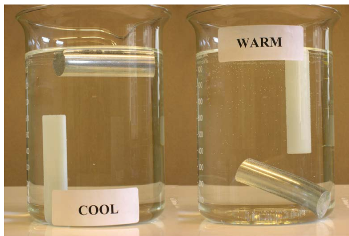
Figura 4.8. Rodillos de aluminio y plástico sumergidos en agua fría y caliente.
