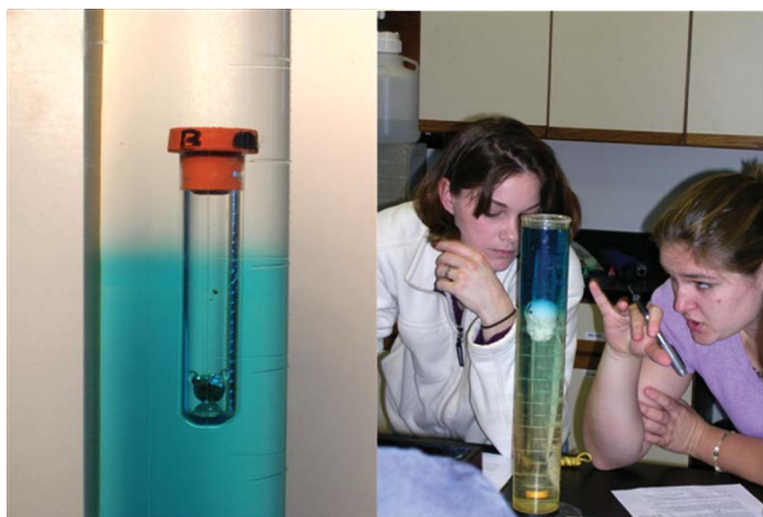
Figura 5.3. Oscilaciones de flotabilidad. Un objeto de densidad intermedia permanece entre una capa de fluido denso situada en el fondo y una capa de fluido menos denso situada en la superficie. Si se le empuja hacia abajo, el objeto comenzará a oscilar con una frecuencia que depende de la diferencia entre las densidades de los fluidos.
