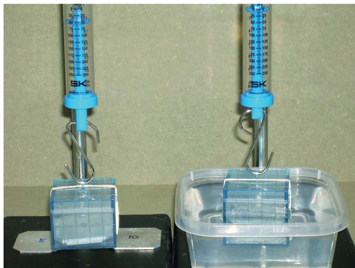
Figura 3.1. Materials per a l'Activitat 3.1 en l'aire (Esquerra, amb dos pesos reposant sobre la taula) i en l'aigua (dreta).
