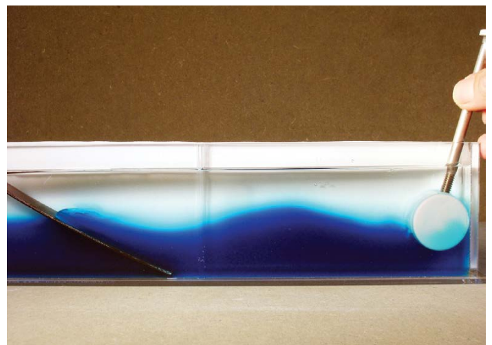
Figura 5.2. Ones internes. Una ona interna en la interfície entre dos fluids de diferent densitat (l'aigua blava és més densa que l'aigua clara). Al costat dret del tanc es mostra la pala d'ones que es pot utilitzar per comprovar la ressonància (veieu explicació en el text), mentre que al costat esquerre s'ensenya una peça de plàstic que simula una topografia canviant.
