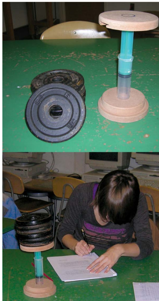
Figura 2.6. (superior) Materials per a l'Activitat 2.6. (inferior) L'instrument quan s'hi han posat al damunt 15 lliures (6,8 kg).
