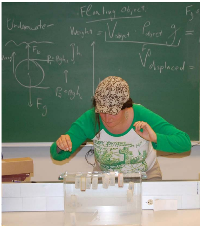
Figura 3.3. Un estudiant comprovant l'Activitat 3.3 “flota” en un tanc estratificat.
