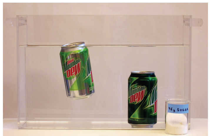
Figura 1.2. Diferença nas densidades e, portanto, comportamentos de afundar e flutuar entre uma lata de refrigerante comum (à direita) e uma lata de refrigerante diet (à esquerda).
