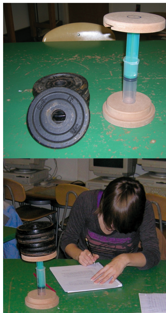
Figura 2.6. (topo) Materiais para a Atividade 2.6. (abaixo) O aparelho após 15 lbs terem sido colocadas em cima.
