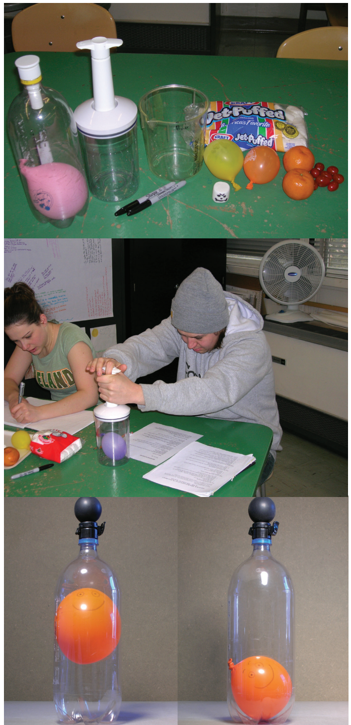
Figura 2.5. (topo) Materiais para a Atividade 2.5. (meio) Testando um recipiente a vácuo cheio de ar. (abaixo) Um balão cheio de ar sob pressão atmosférica (esquerda) e depois de ar ser bombeado para dentro da garrafa (pressão aumentada; direita).
