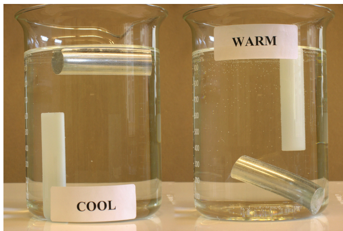
Figura 4.8. Hastes de alumínio e plástico imersas em água fria e quente
