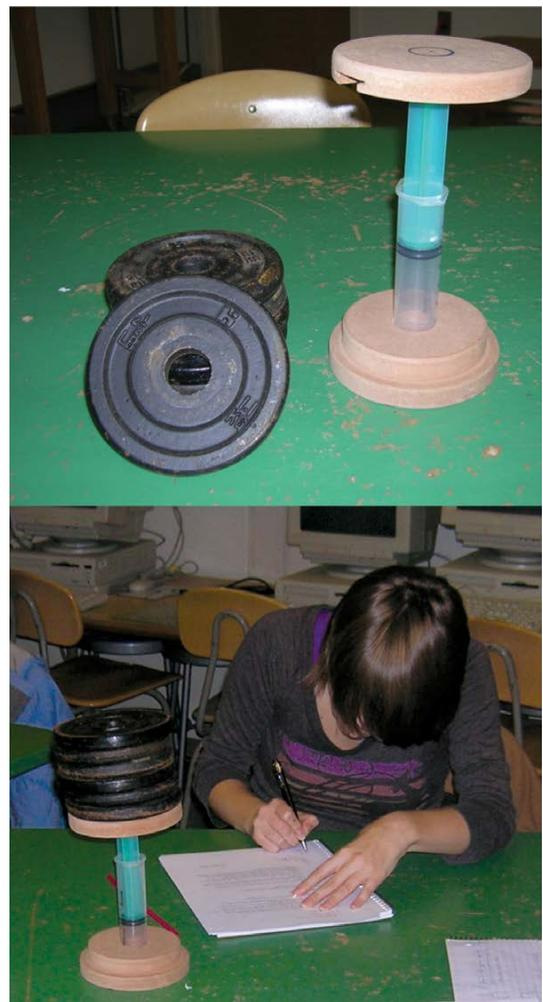
Figura 2.6. (topo) Materiais para a Atividade 2.6. (abaixo) O aparelho após 15 lbs terem sido colocadas em cima.
