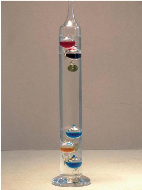
Figura 1.7. Um termômetro de Galileu.
