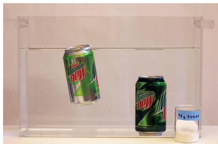
Figura 1.2. Diferença nas densidades e, portanto, comportamentos de afundar e flutuar entre uma lata de refrigerante comum (à direita) e uma lata de refrigerante diet (à esquerda).
