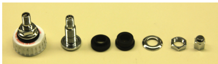
图三、瓶盖改装所需要的零件照片。左边是一个完全组装好的瓶盖，右边是轮胎气嘴的各项零件。瓶盖夹在两个黑色密封垫之间，压紧式轮胎气嘴可以在在线购买或者在汽车配件商店购买。
