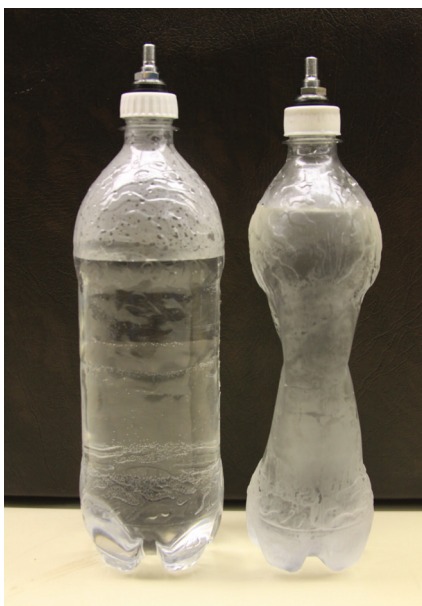
图五、左边的瓶子装的是温热水，右边的瓶子装的是冰水。先将顶部空间中原有的空气挤出后，将两个瓶子装满二氧化碳后摇动混和。注意两个瓶子之间的压力差异。
