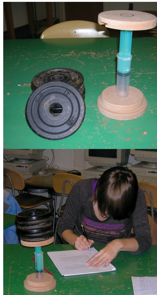
Figura 2.6. (superior) Materiales para la Actividad 2.6. (inferior) El instrumento cuando se han colocado encima 15 libras (6.8kg).
