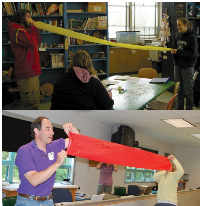
Figura 2.7. (superior) Un estudiante intentando llenar la bolsa mientras la tiene pegada a sus labios (inferior) Cuando se mantiene la bolsa completamente abierta y se sopla desde una distancia hacia la apertura, la bolsa puede llenarse con un solo soplo.
