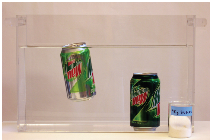
Figura 1.2. Diferencia en densidades y, por tanto, en hundimiento y flotación entre una lata de gaseosa ordinaria (derecha) y una lata de gaseosa sin azúcar (izquierda).
