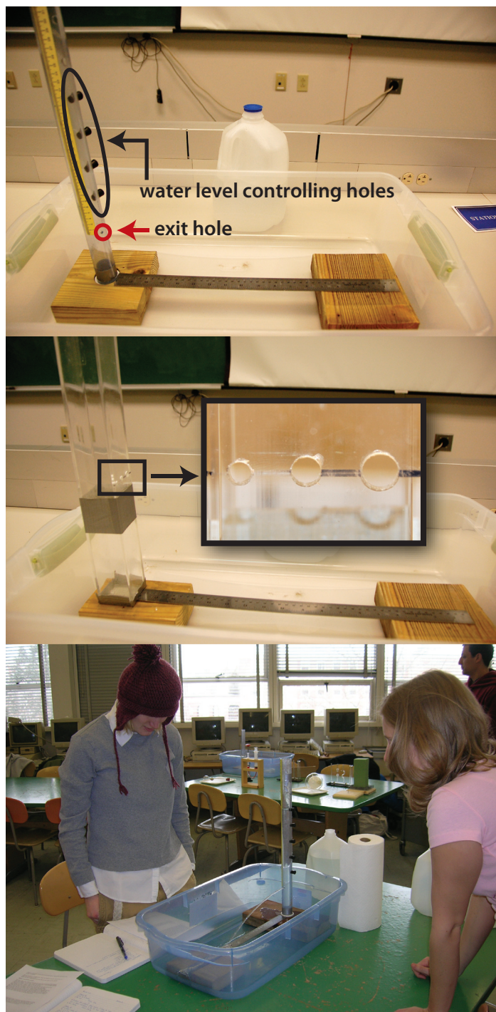
Figura 2.3. Materials per a l'Activitat 2.3, Part A (superior) i Part B (centre). A la figura superior, l'expressió "water level controlling holes" assenyalava els forats grans al llarg del tub obstruïts amb taps de goma; "exit hole" indica el petit forat per a la sortida del líquid. Estudiants portant a terme la Part A (inferior).
