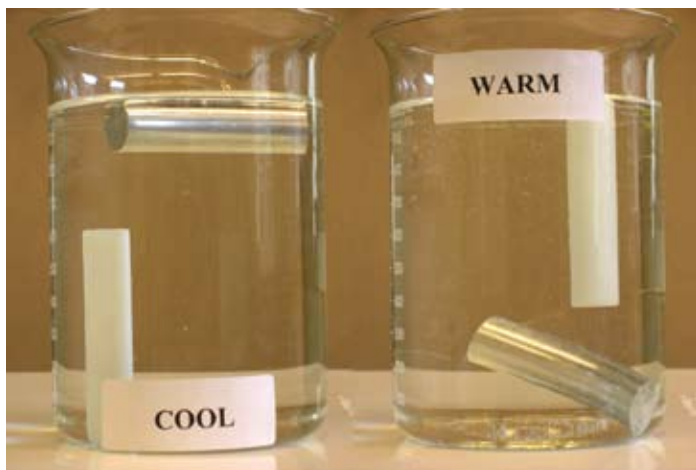
Figura 4.8. Corrons d'alumini i plàstic submergits en aigua freda i calenta.
