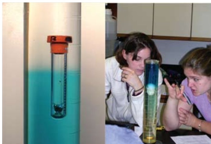
Figura 5.3. Oscil·lacions de flotabilitat. Un objecte de densitat intermèdia roman en repòs entre una capa de fluid més densa al fons i menys densa a la superfície. Si l'objecte és empès cap avall, aquest oscil·larà amb una freqüència que dependrà de la diferència entre les dues densitats.
