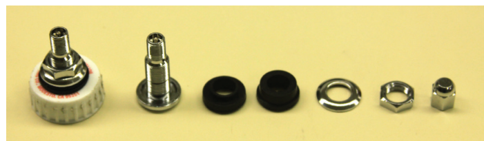
圖三、瓶蓋改裝所需要的零件照片。左邊是一個完全組裝好的瓶蓋，右邊是輪胎氣嘴的各項零件。瓶蓋夾在兩個黑色密封墊之間，壓緊式輪胎氣嘴可以在線上購買或者在汽車配件商店購買。
