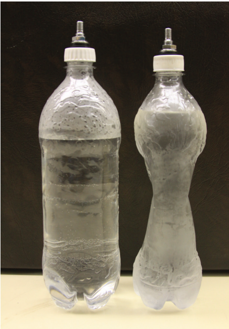
圖五、左邊的瓶子裝的是溫熱水，右邊的瓶子裝的是冰水。先將頂部空間中原有的空氣擠出後，將兩個瓶子裝滿二氧化碳後搖動混和。注意兩個瓶子之間的壓力差異。
